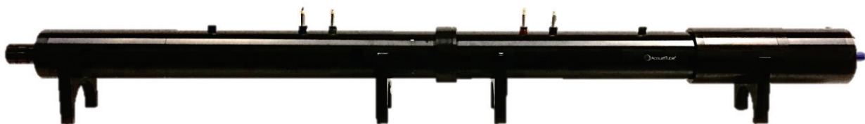
Abbildung 1: Impedanzrohr zur Messung von Absorptions- und Transmissionsgrad
