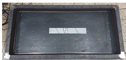
Abbildung 5: Platte (8 mm Dicke) mit Nut und zentraler Position des Dämpfers.
