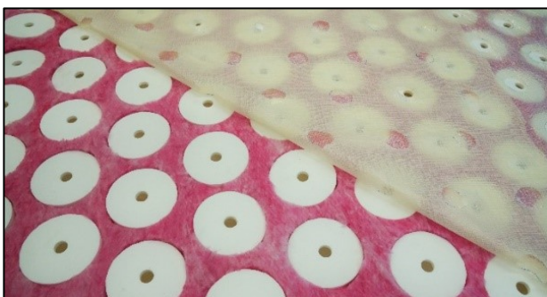
Abbildung 5: Modifikation der herkömmlichen Glaswolle durch eingebettete Resonatoren
