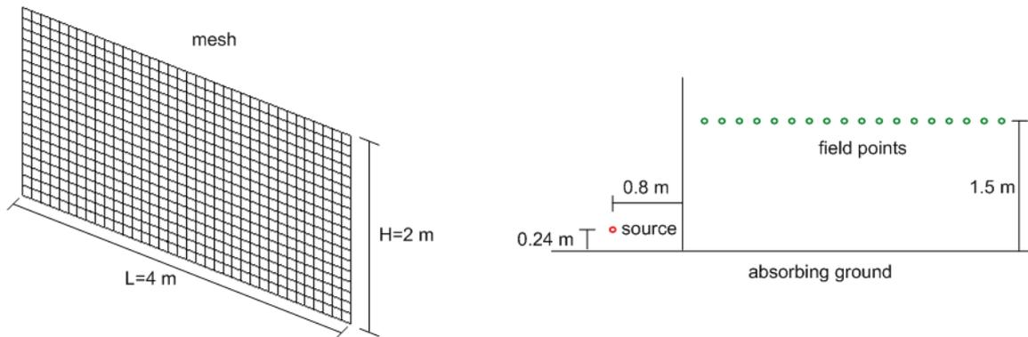
Figure 3 – Simulation parameters
