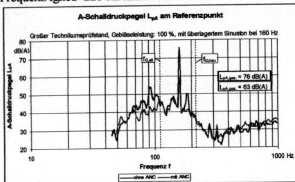
Bild 2: ANC im durchströmten, unterteilten Kanal
