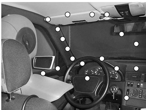
Abb. 1: Kunstkopfmesssystem im Fahrsimulator und Auswahl einiger Mikrofonpositionen
