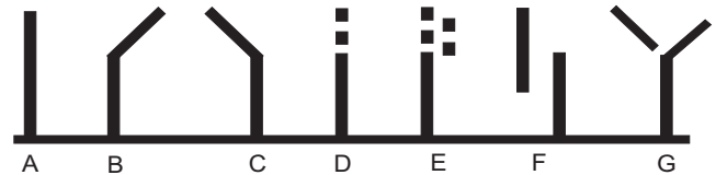
Abb. 1: Profile der sieben verschiedenen, jeweils 3 m hohen Schallschutzschirme. Die Schallquelle befindet sich jeweils links vom Schirm.
