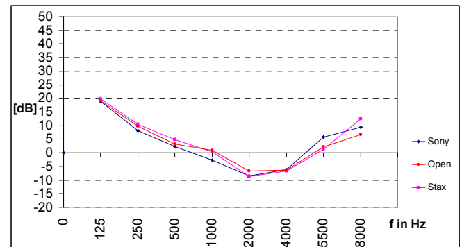
Abb. 5: Hörschwellenmessung: Ergebnisse für verschiedene Kopfhörer
