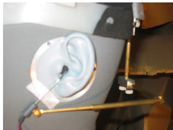
Abb. 3: Montage der Sondenmikrofone (am Kunstkopf)
