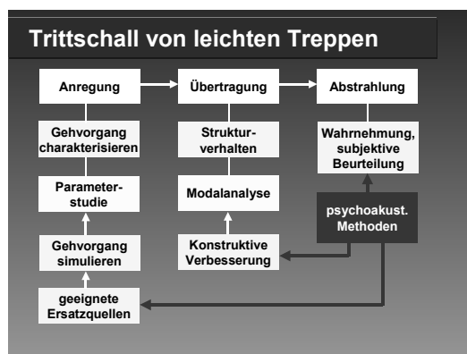
Bild 1: Schema der Vorgehensweise zur Untersuchung der schalltechnischen Eigenschaften von leichten Treppen
