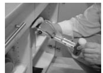
Abbildung 1: Pendelhammer zur Simulation haustechnischer Benutzungsgeräusche. Oben: Vertikalschlag; unten: Horizontalschlag.
