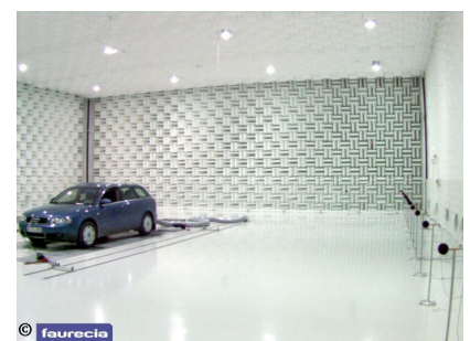
Abbildung 2: Messung in einem reflexionsarmen Raum
