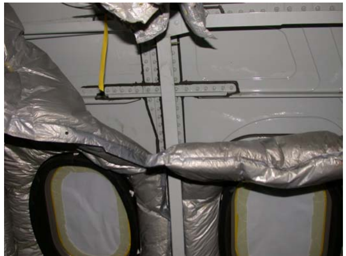
Abb 1: Außenhaut einer Flugzeugkabine mit abgenommenen Panels und teilentfernter thermischer Isolierung
