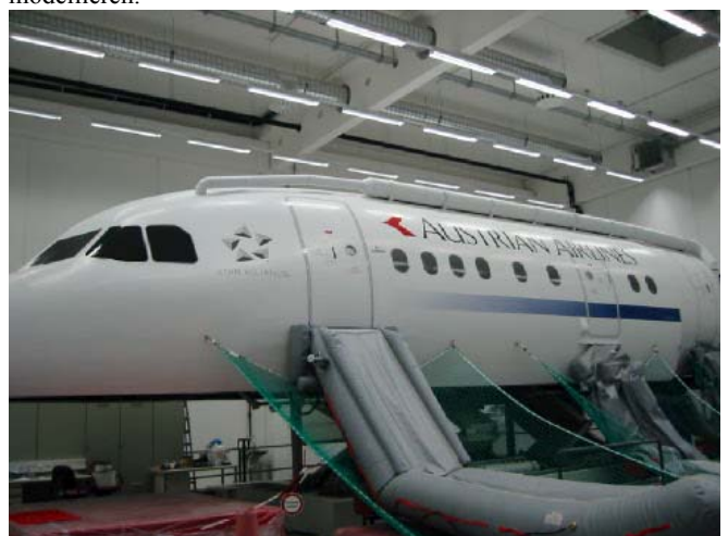
Abb. 2: In HEACE benutzter Kabinensimulator („mock-up“)
