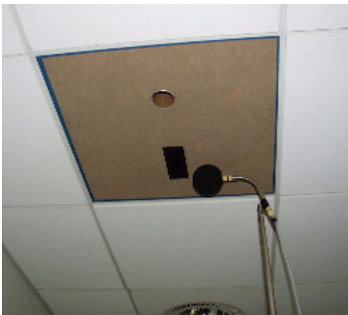
Bild 1 Öffnungen und Mikrofonposition
