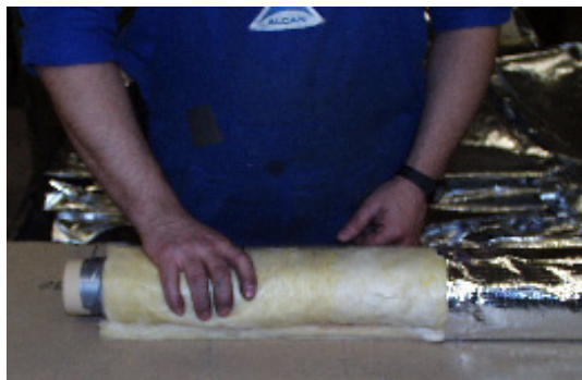
Bild 4 Schalldämpfer mit dünner Außenhaut
