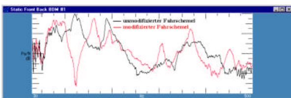
Abbildung 5: Messungen elast. Kopplung, Vergleich modifizierter und unmodifizierter Fahrschemel
