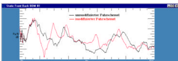
Abbildung 6: Synthesen elastische Kopplung, Vergleich modifizierter und unmodifizierter Fahrschemel.
