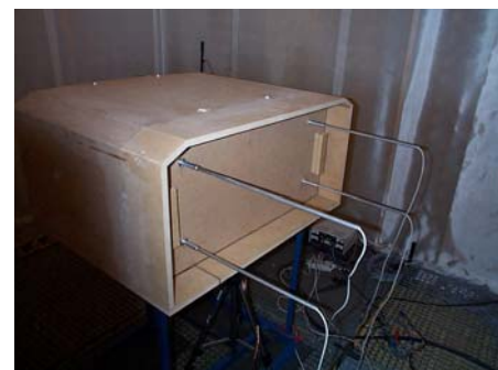
Abbildung 3: Einschub der vier Messmikrofone durch die Stirnwand
