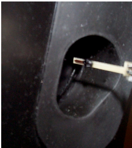
Bild 4: Microflow-Sensor im Ohrkanal
