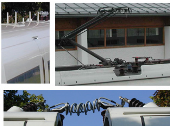
Abbildung 1: Aerodynamische Schallquellen des ICE 3 auf dem Fahrzeugdach: Antennen oben links, Stromabnehmer oben rechts, Kabel und Isolatoren unten
