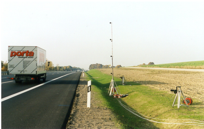
Abbildung 1: Messanordnung bei der kontrollierten und bei der statistischen Vorbeifahrt.
