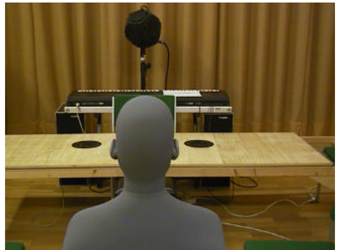
Abbildung 1: Anordnung der BiegeWellenwandler zur Simulation der Schallabstrahlung eines offenen Flügels.
