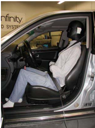
Abbildung 1: Binaurale Messung im Auto.
