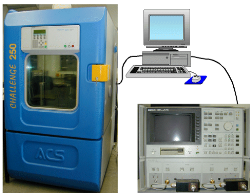
Abbildung 5: Messaufbau zur Charakterisierung der Sensoren
