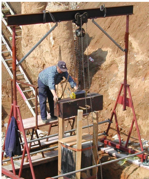
Bild 1: Stoß-Erzeugung mit 800 kg Hebevorrichtung
