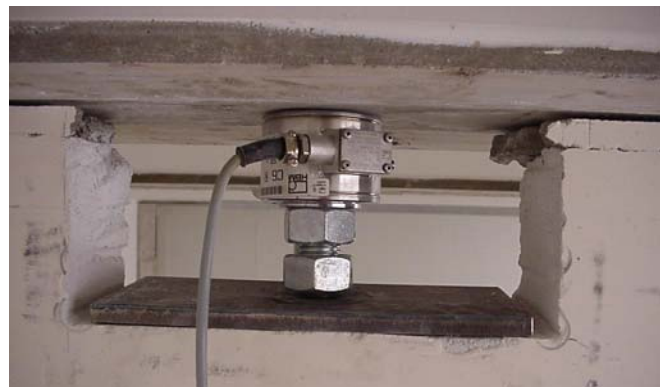
Abbildung 2: Kraftmesser mit Gewinde zum Aufbringen der Last.
