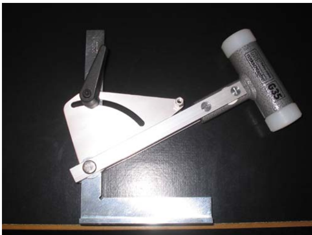
Abbildung 1: Pendelfallhammer zur Simulation von Nutzergeräuschen
