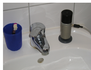
Abbildung 3: Kleinhammerwerk zur Körperschallanregung auf einem Waschbecken
