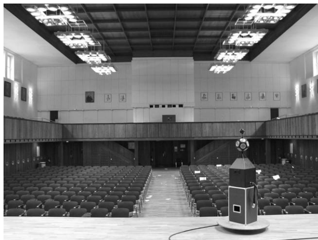
Abbildung 1: Aula der RWTH Aachen – Auf dem Drehteller ist der ITA-Messlautsprecher in seiner Auralisations-Konfiguration (A) positioniert.
