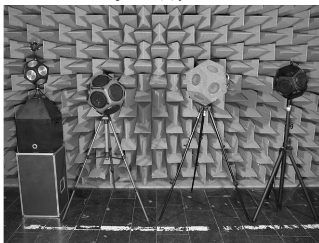
Abbildung 2: Messlautsprecher im Test: ITA, Norsonic (neueres Modell), Norsonic (älteres Modell), B&K
