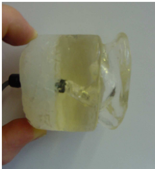
Abbildung 1: Silikon-Ohr rechts mit Silizium-Mikrofon
