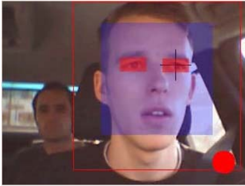
Abbildung 2: Erkennung des Kopfes, der Gesichtsregion und relevanter Gesichtsm Merkmale in einer Fahrzeugumgebung
