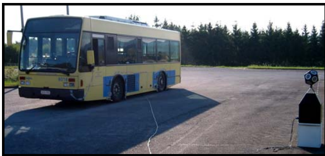
Abbildung 2: Reziproke Messung der Luftschallübertragungsfunktionen an einem Bus. Punktschallquelle am rechten Bildrand.
