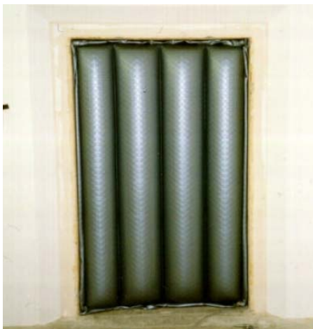
Abbildung 1: Luftkissenelement im Türenprüfstand
