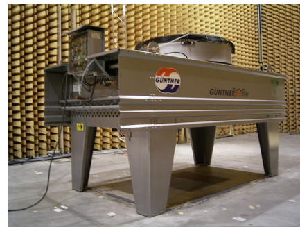
Abbildung 1: Luftgekühlter Verflüssiger/Rückkühler, aufgestellt im reflexionsarmen Raum des Fraunhofer Institutes für Bauphysik
