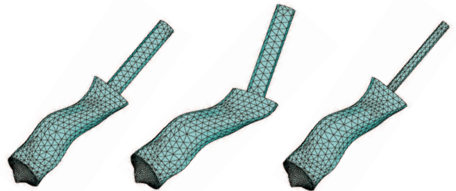
Abbildung 1: Finite-Elemente-Modelle der Messköpfe (links: Durchmesser 5 mm, Mitte: Durchmesser 5 mm, leicht geneigt, rechts: Durchmesser 2,5 mm).
