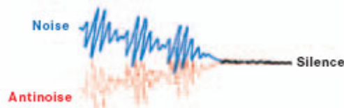
Abbildung 2: Prinzip aktiver Lärm-/Schwingungsbekämpfung.
