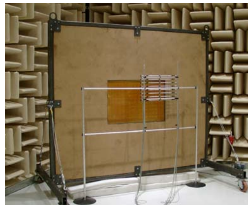
Abbildung 1: Bauteilprüfstand mit 96-kanaligem Mikrofonarray im reflexionsarmen Halbraum des Fraunhofer IWU
