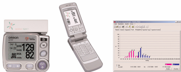
Abbildung 2: Individualisiertes, vollautomatisches Blutdruckmesssystem des Heinz Nixdorf-Lehrstuhls mit Datenbank-Zugang
