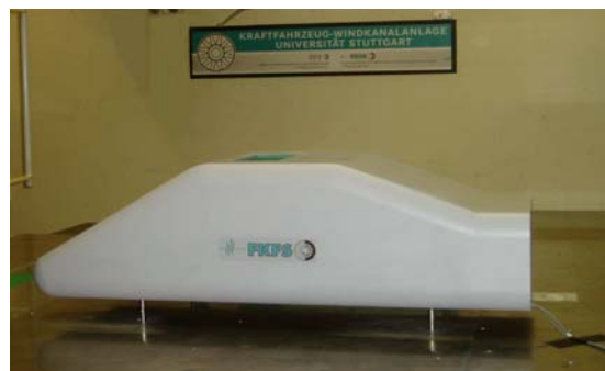
Abbildung 2: 1:4-SAE-Modell mit Schiebedachöffnung und variablem Hohlraum im FKFS-Modellwindkanal.
