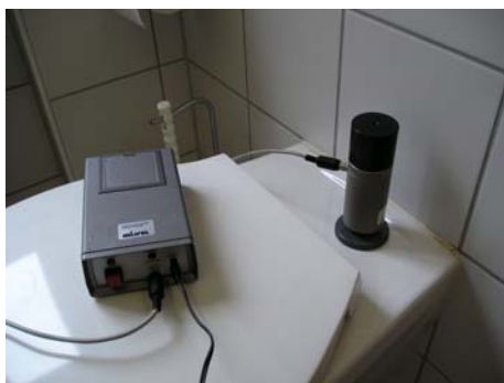
Abbildung 3: Kleinhammerwerk zur Körperschallanregung auf einem WC-Becken
