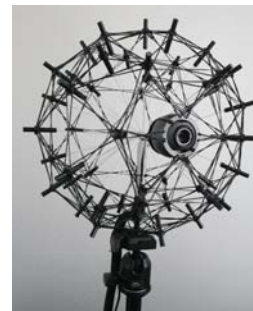
Abbildung 6: Kugelarray (48 Kanäle, Ø 35cm) der Firma GFaI.
