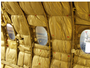
Abbildung 1: Innenansicht der isolierten Hautfelder des Testrumpfes einer Dornier-328.
