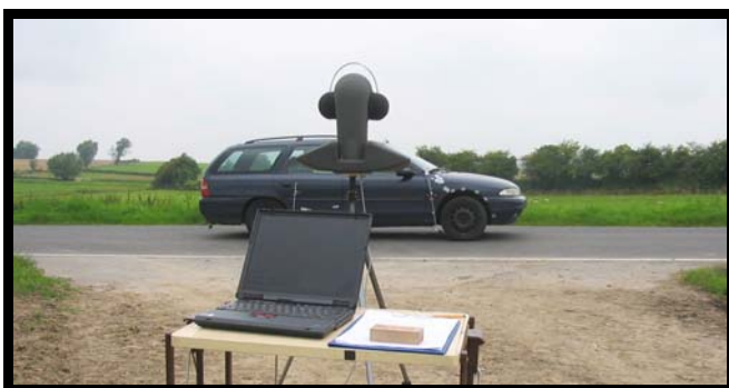
Abbildung 1: Messung der Vorbeifahrtsgeräusche
