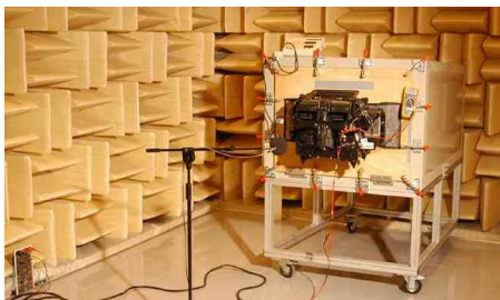
Abbildung 3: Aufbau eines Klimageräts im Halbfreifeldraum in der Testvorrichtung
