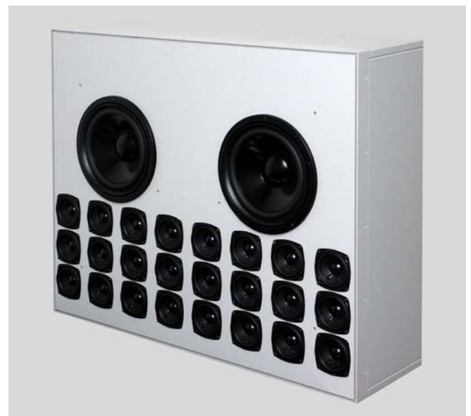
Abbildung 2 Achtkanaliges Lautsprechermodul mit Breitbandsystemen in 10 cm Abstand und Tieftönern in 40 cm Abstand
