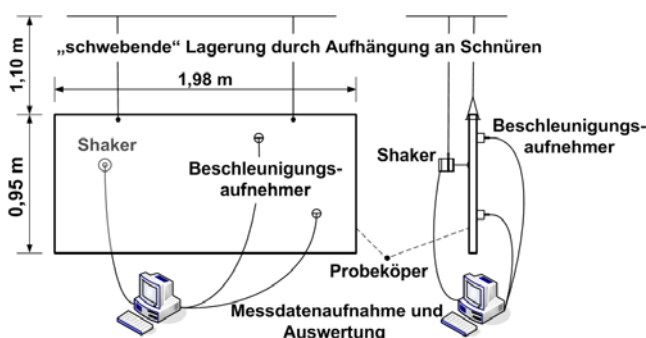
Abbildung 1: Schematische Darstellung des Messaufbaus zur Bestimmung des inneren Verlustfaktors von Leichtbauplatten [6].
