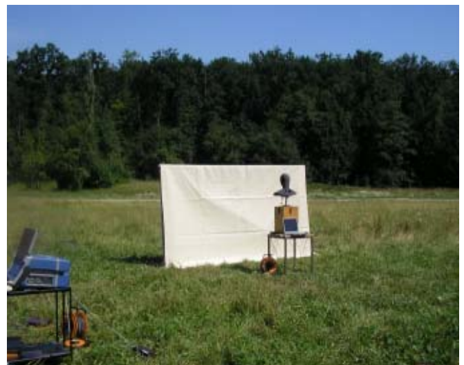
Abbildung 1: Pegelmessungen und Kunstkopfaufnahmen an einer Stellwand aus Folien und Membranen im Freien
