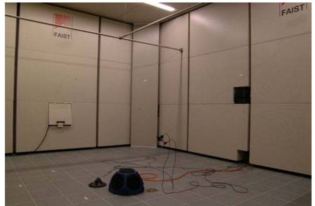
Abbildung 2: Ansicht des fertigen Halbfreifeldraumes mit der Quelle in Raummitte bei der Raumabnahme auf dem Boden (ohne schallharte Zusatzwand).
