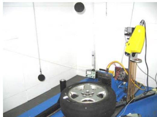
Bild 1: Testaufbau zur strukturdynamischen und akustischen Vermessung eines ruhenden, deformierten Reifens.
