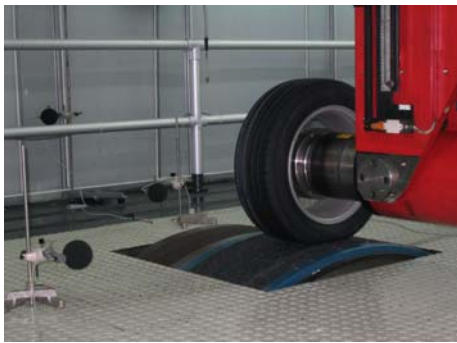
Bild 3: Testaufbau eines Trommelprüfstandes mit Myra-Texture in einem schallarmen Raum
