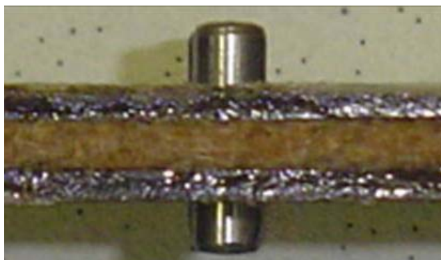
Abbildung 3: Sandwichplatte S106 (Dicke: 14 mm, Masse pro Fläche: 10 kg/m 2 , Deckschichten: Hanf/Epoxid 40/60, Kernschicht: Flachs/Jute 30/70).
