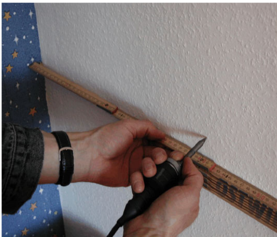
Bild 1: ICP-Aufnehmer mit Tastspitze und Messergebnisse
