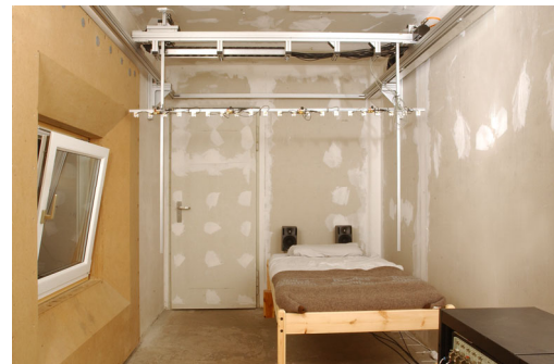
Abbildung 2: Hallraum mit Bett und Mikrofonfeld bei gekipptem Fenster
