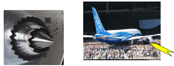
Chevron Nozzle an einer CF-34 Engine, ASME 2006. Michel, DLR (2003): 1-3 dB bei 1% Treibstoffmehrerbrauch. http://www.memagazine.org/nov05/features/nozzle/nozzle.html
